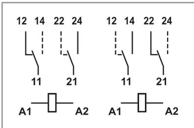
根據EN 61810-3 (類型B)，可提供強制導引 (機械性連接) 觸點的常開和常閉觸點備用選擇。
